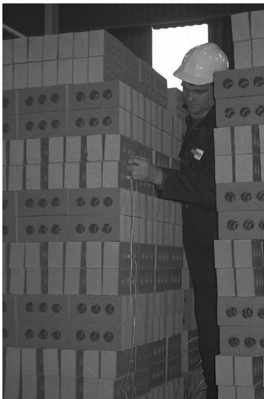
焼成期間にレンガをモニタする準備の整ったキルン温度トラッカーシステム
