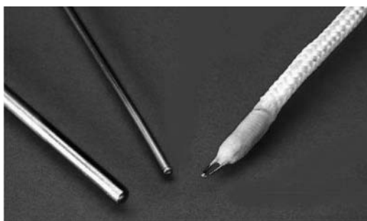
熱電対の熱接点の詳細図
