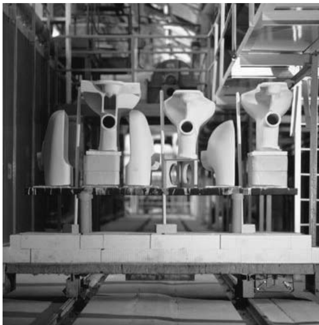
衛生器具をロードし、出発準備の整ったキルンカー
