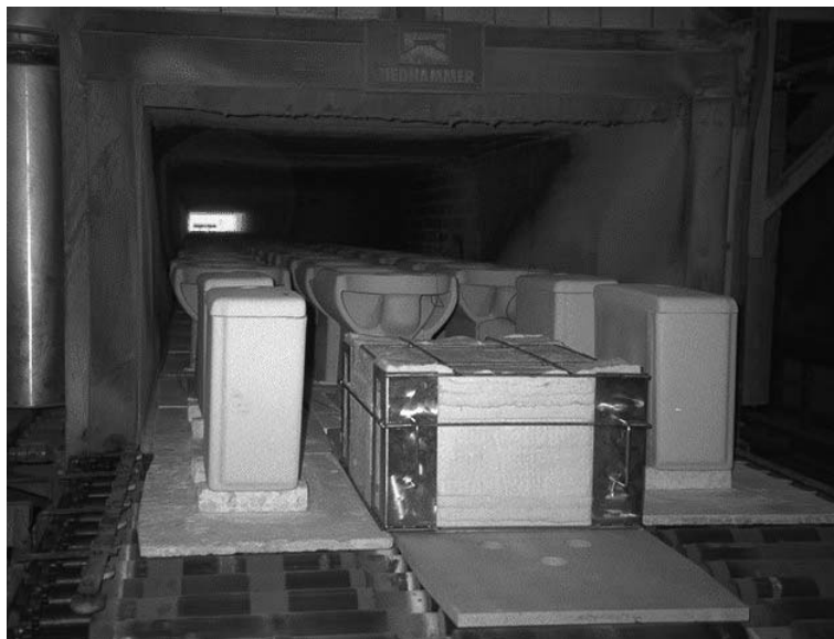
キルンに入るトラッカーシステム
