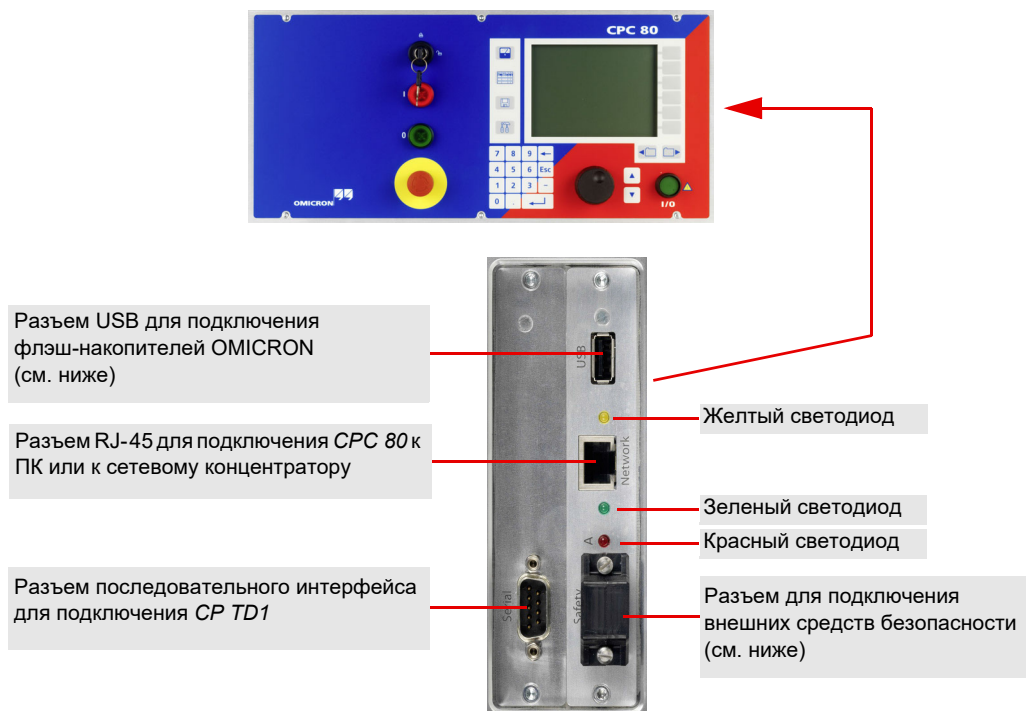
Рис. 2-6: Интерфейсы встроенного ПК CPC 80
