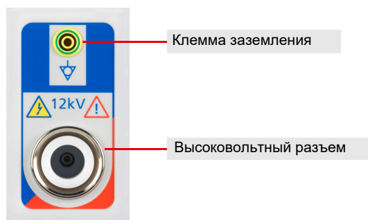
Рис. 2-11: Высоковольтный разъем CP TD1 (сзади на устройстве)
