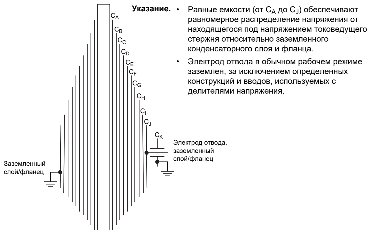
Рис. 6-1: Конструкция конденсаторного ввода
