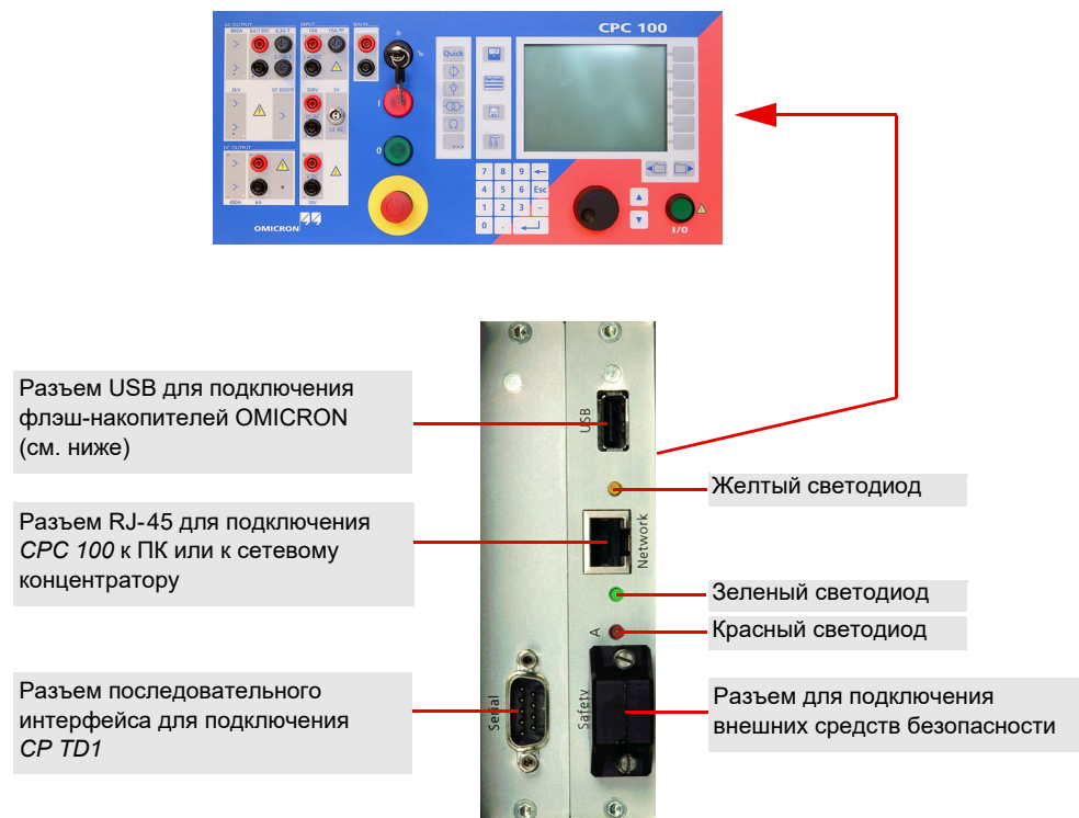
Рис. 2-3: Интерфейсы встроенного ПК CPC 100 версии V1
