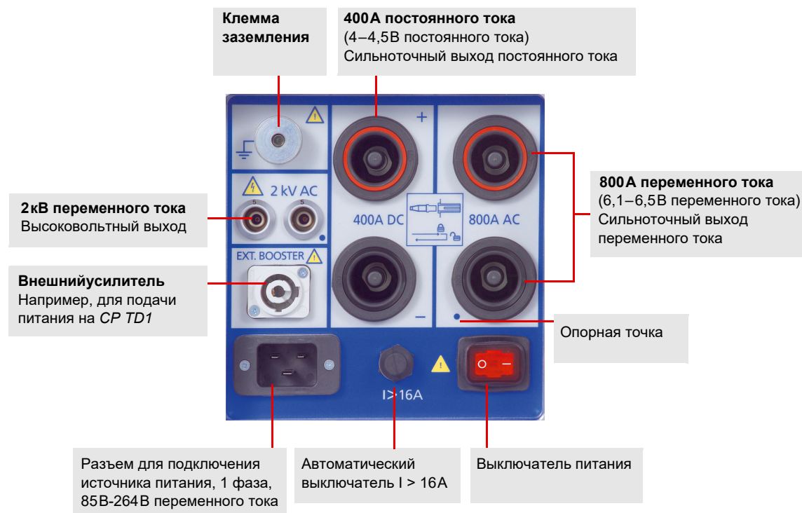
Рис. 2-2: Высоковольтные и сильноточные выходы с левой стороны CPC 100
