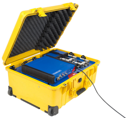
Figura 4-2: Conexión del FRANEO 800 al ordenador mediante el cable USB 2.0 A/B suministrado
