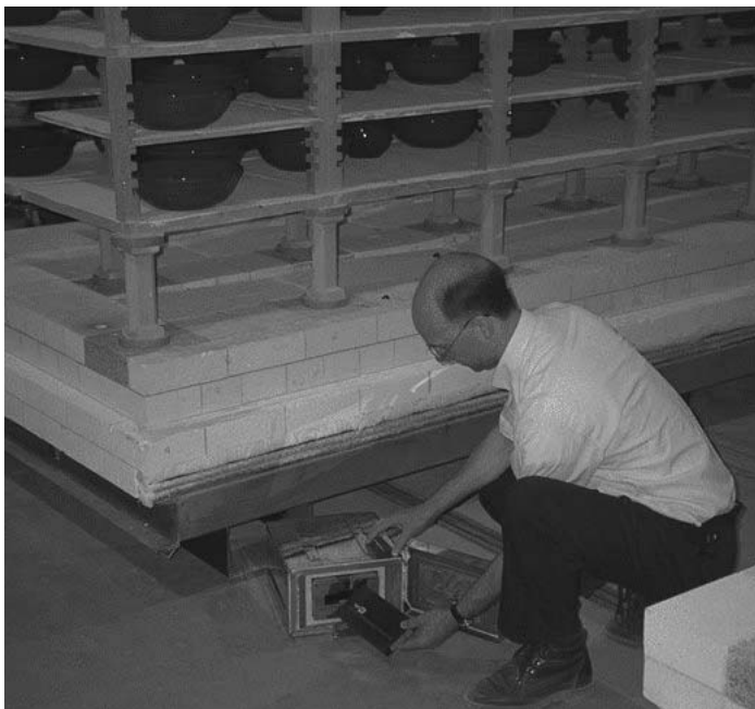
Installation d'un enregistreur de données dans un bouclier thermique
