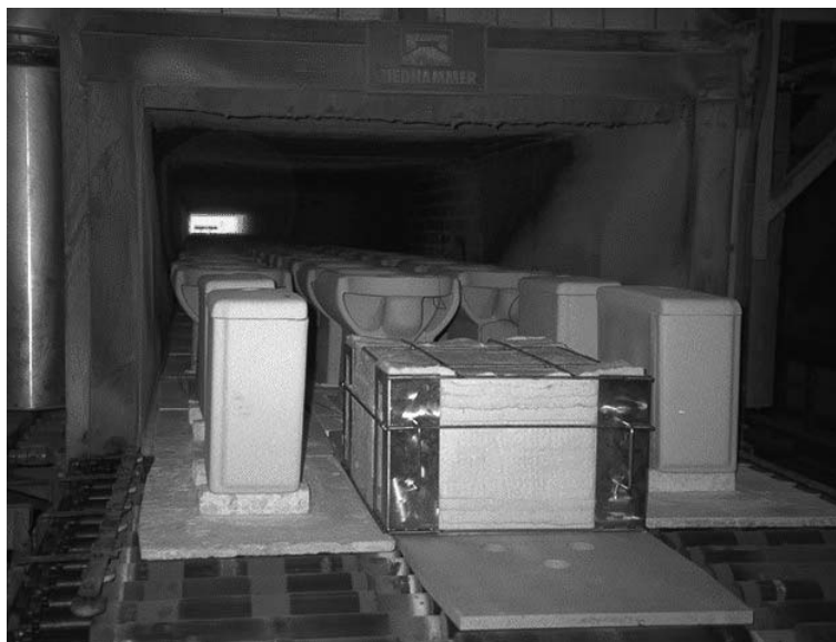
Introduction du système Tracker dans un four.
