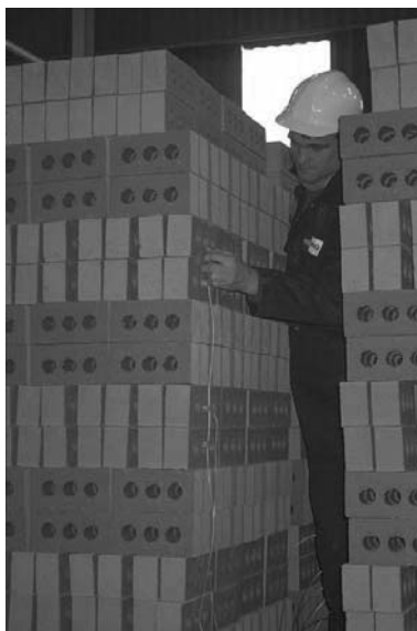
Contrôle des briques par le système Kiln Tracker pendant la cuisson.
