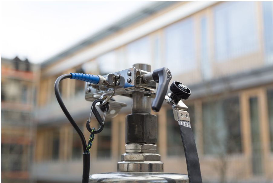
Figure 5-7: Connexion du câble coaxial bleu à la pince pour traversée à l'aide du mécanisme de détente au niveau du blindage BNC
