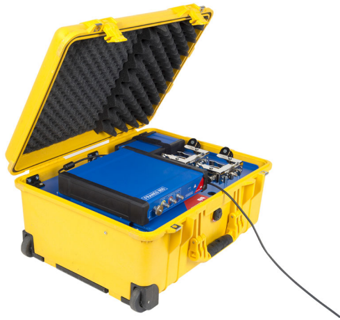
Figure 5-2: Connexion du FRANEO 800 à l'ordinateur à l'aide du câble USB 2.0 A/B fourni
