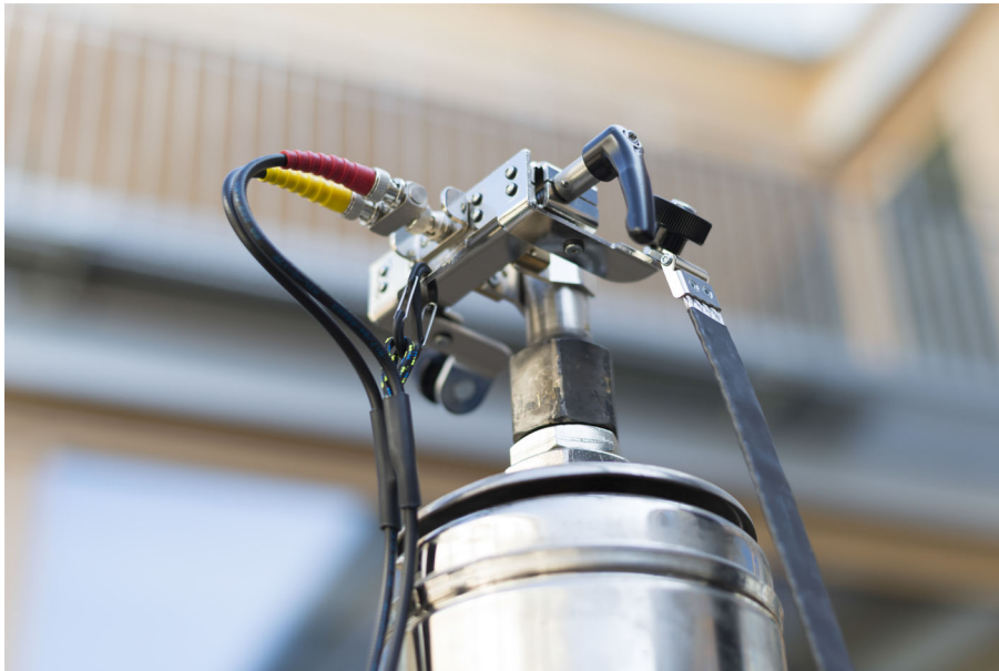
Figure 5-4: Connexion des câbles coaxiaux jaune et rouge à la pince pour traversée à l'aide du mécanisme de détente au niveau du blindage BNC
