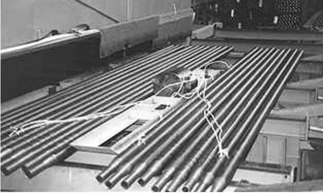
高温炉温度跟踪仪系统已做好在退火过程中监控管子的准备
