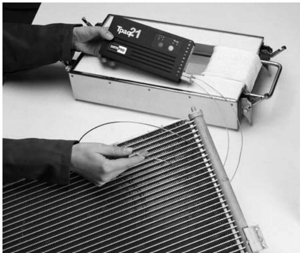
热电偶探头正在被附接到散热器试件上
