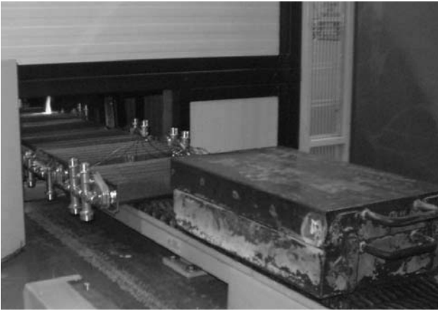
探头附接在试件上的高温炉隔热箱
