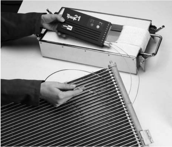
Sondes fixées à un radiateur de pièce test
