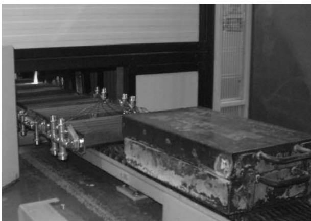
Bouclier thermique avec sondes fixées à la pièce test
