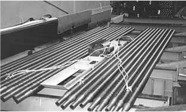
Système Furnace Tracker prêt à contrôler des tubes lors d'un traitement de recuisson.
