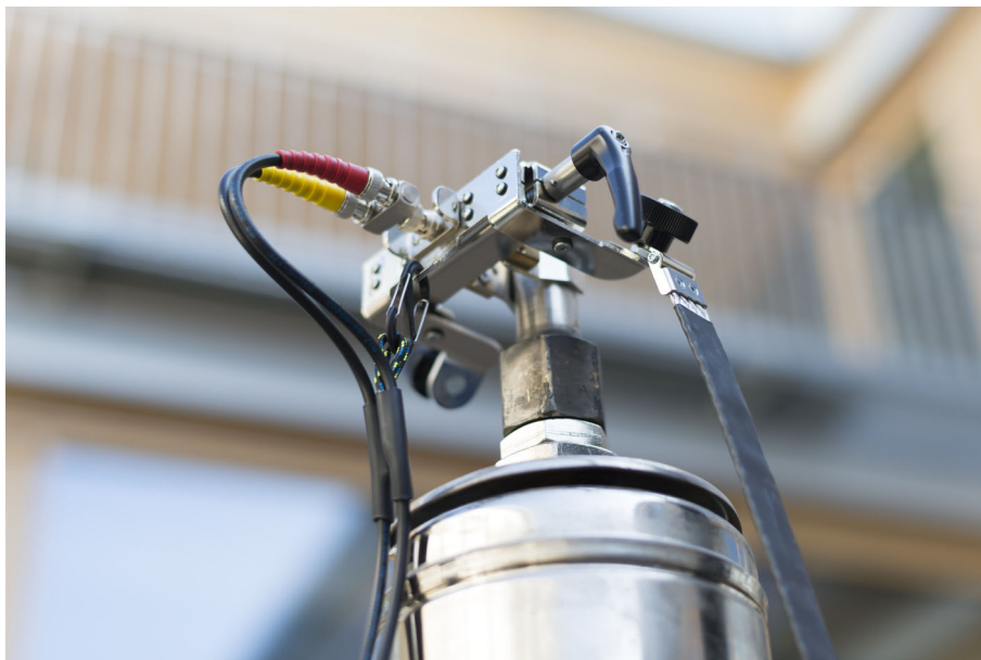
Фигура 4-4: Свързване на жълтия и червения коаксиални кабели към съединителната скоба с използване на механизма за напрежението от опъване върху BNC
