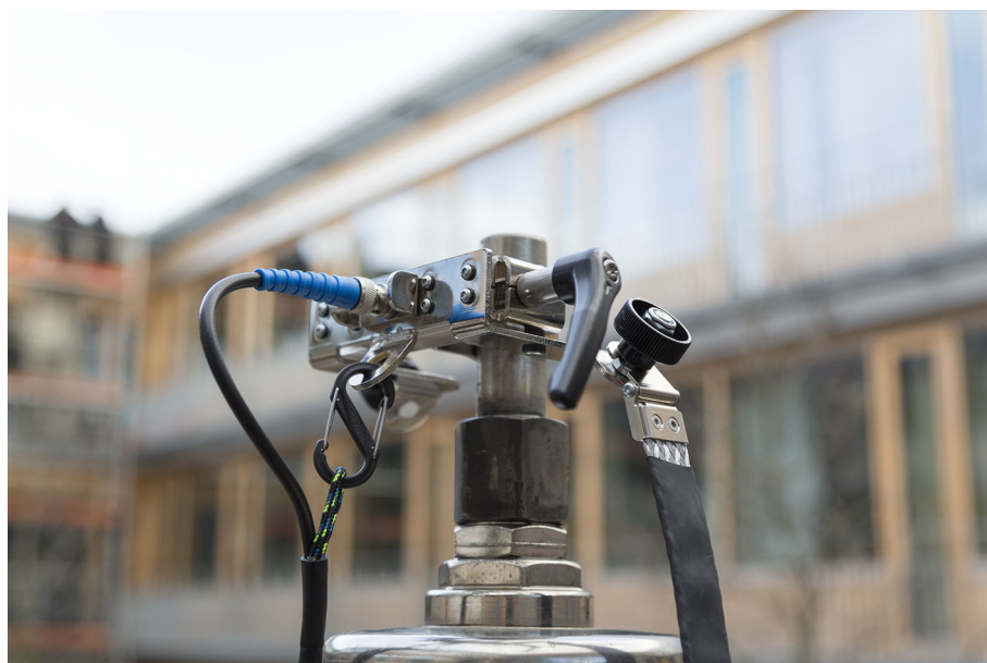
Фигура 4-7: Свързване на синия коаксиален кабел към съединителната скоба с използване на механизма за напрежението от опъване върху BNC
