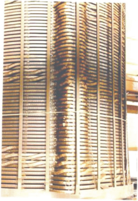
Figura 3-3: Deformazione radiale della bobina
