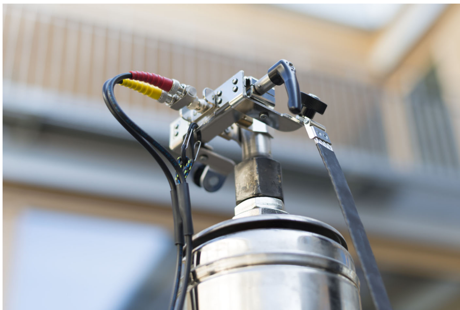
Figura 4-4: Collegare i cavi coassiali giallo e rosso alla staffa degli isolatori usando il meccanismo di depressurizzazione della schermatura BNC.
