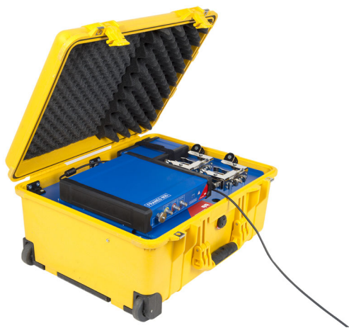
Figura 4-2: Collegare FRANEO 800 al computer usando il cavo USB 2.0 A/B in dotazione
