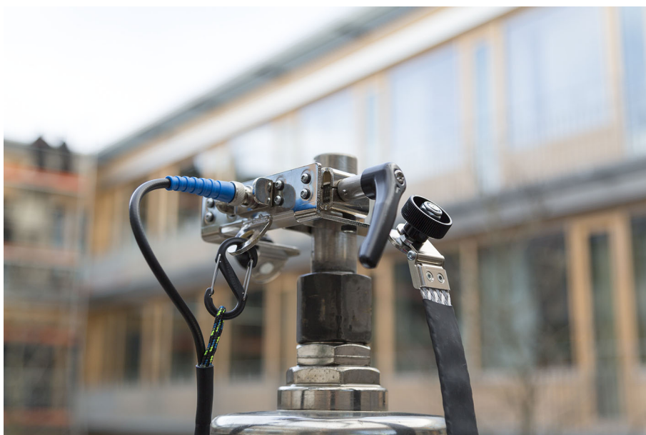
Figura 4-7: Collegare il cavo coassiale blu alla staffa degli isolatori usando il meccanismo di depressurizzazione della schermatura BNC.
