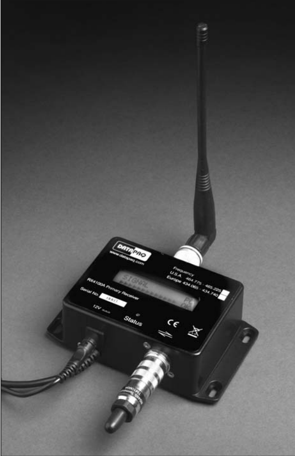
TM21 主接收器: 螺旋管 (“鞭状”) 天线接在上侧, 左下侧为 USB 连线, 右下侧为插入从接收器插座的 RS485 终端电阻。
