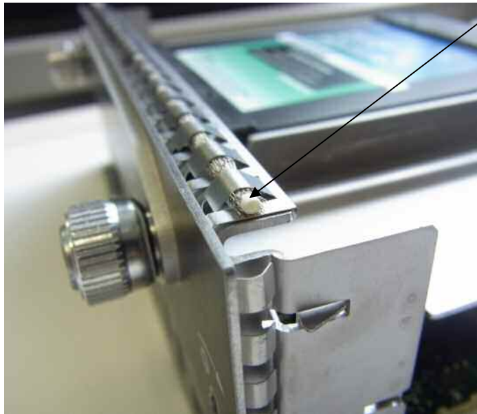
Pos. 192 in Modulschirmfeder PC eingelegt und beide Enden mit Silikon abgeklebt/ mounted in shielding gasket PC and both ends glued with silikone
