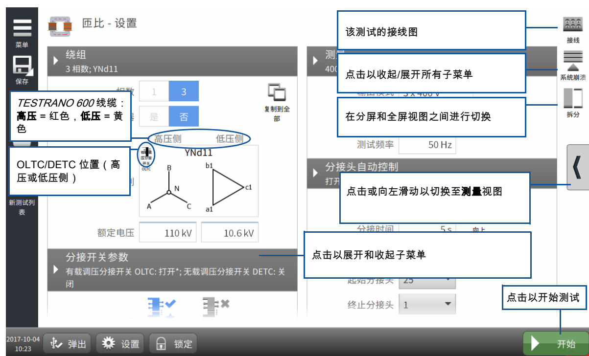
图 5-1：匝比测试 – 设置视图
