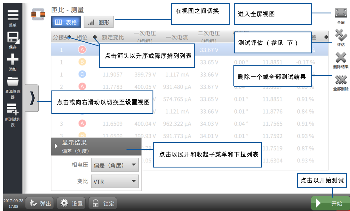
图 5-2：匝比测试 – 测量视图
