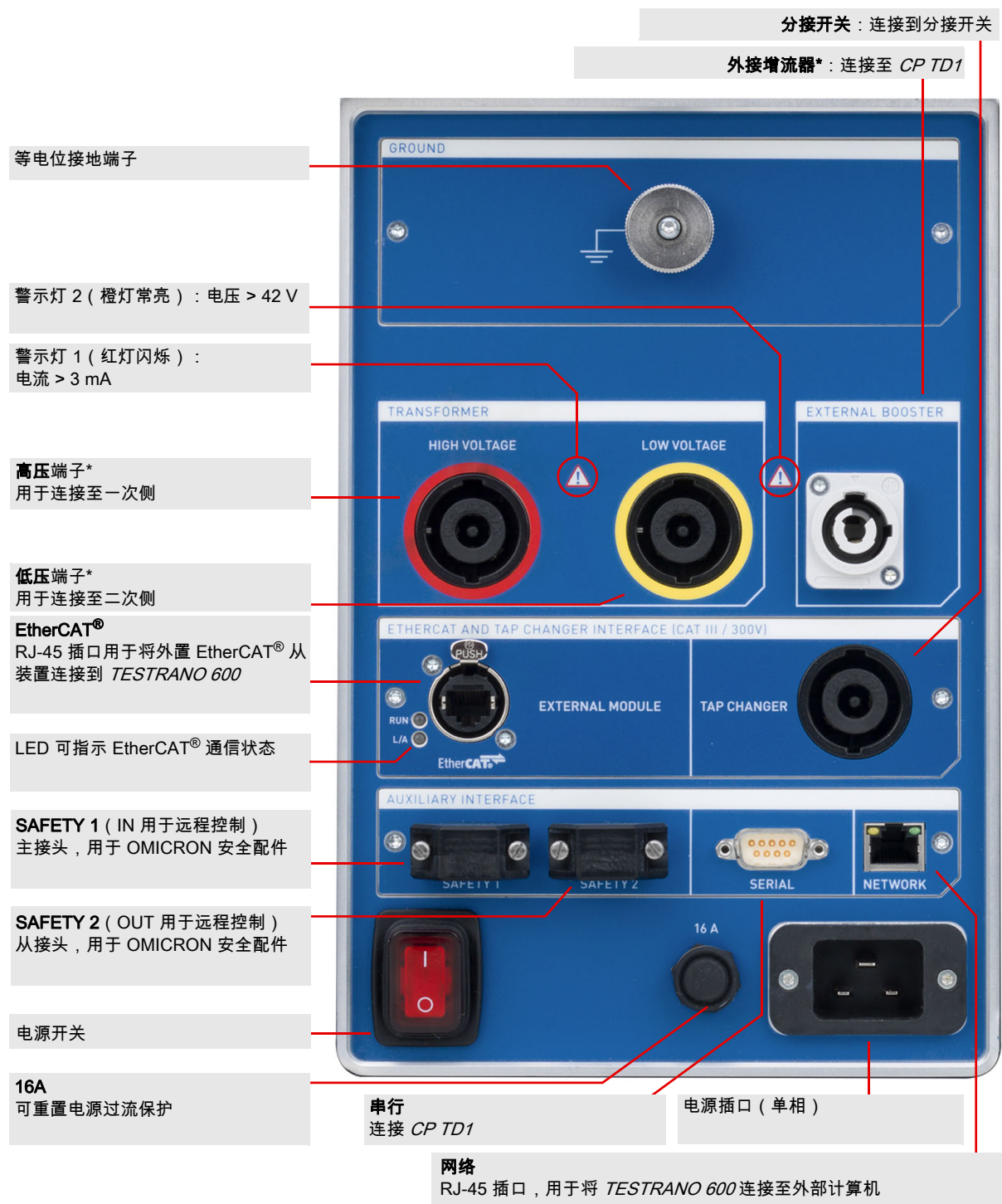
图 3-2 : TESTRANO 600 侧面板
