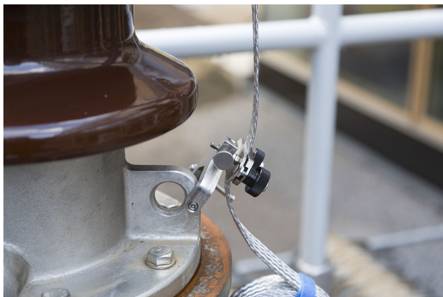
Figura 5-6: Método alternativo para fijar la pinza de tornillo
