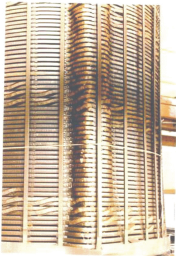
Figura 3-3: Deformación radial de la bobina
