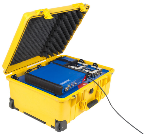
Figura 5-2: Conexión del FRANEO 800 al ordenador mediante el cable USB 2.0 A/B suministrado
