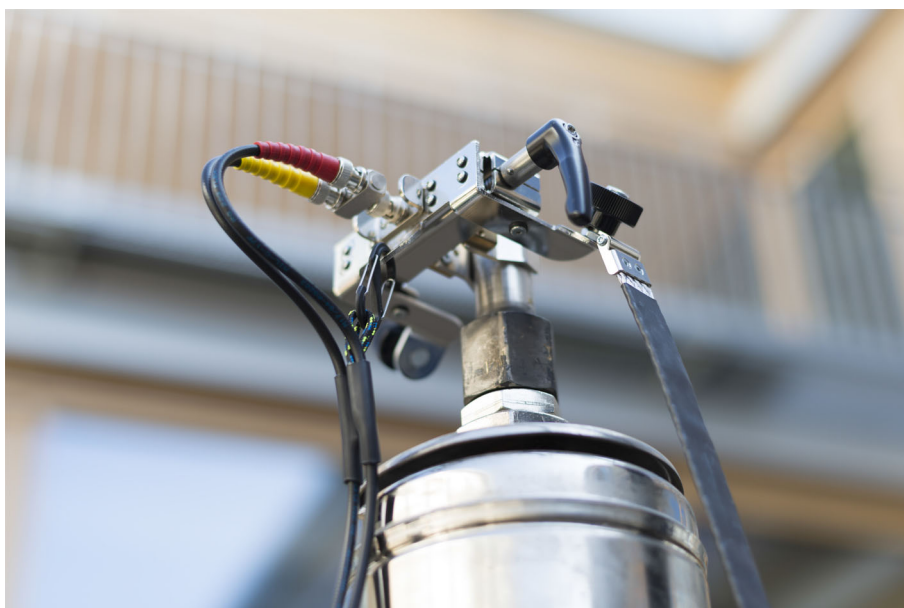
Figura 5-4: Conexión de los cables coaxiales amarillo y rojo con la pinza para borna mediante el mecanismo para liberar la presión del blindaje BNC
