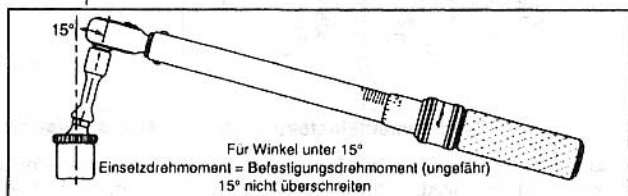
Abb. 6—Verwendung von Wobblerverlängerungen/Universalschlüsseln mit Drehmomentschlüsseln.
