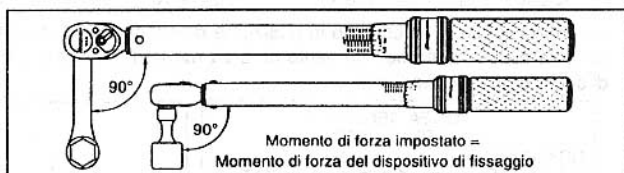
Fig. 5 - Il momento di forza del dispositivo di fissaggio è uguale al momento di forza del quadrato della trasmissione della chiave torsionometrica.
