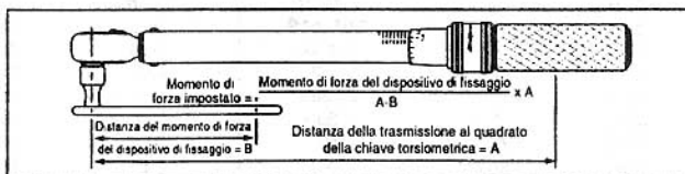
Fig. 9 - Il momento di forza del dispositivo di fissaggio è minore del momento di forza della trasmissione al quadrato della chiave torsionometrica.
