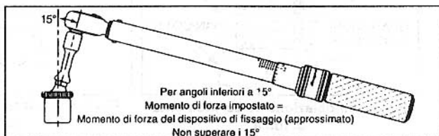
Fig. 6 - Uso di prolunghe/accessori universali oscillanti con le chiavi torsionometriche
