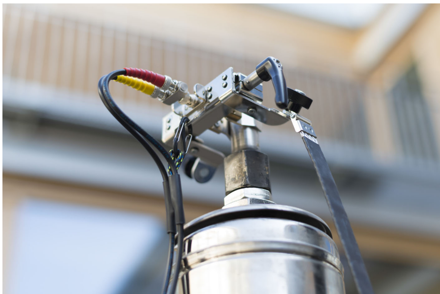
Figura 5-4: Conectando os cabos coaxiais amarelo e vermelho ao grampo de bucha usando o mecanismo para aliviar a pressão na blindagem BNC
