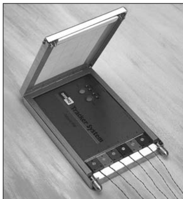
Enregistreur placé dans son bouclier thermique.
