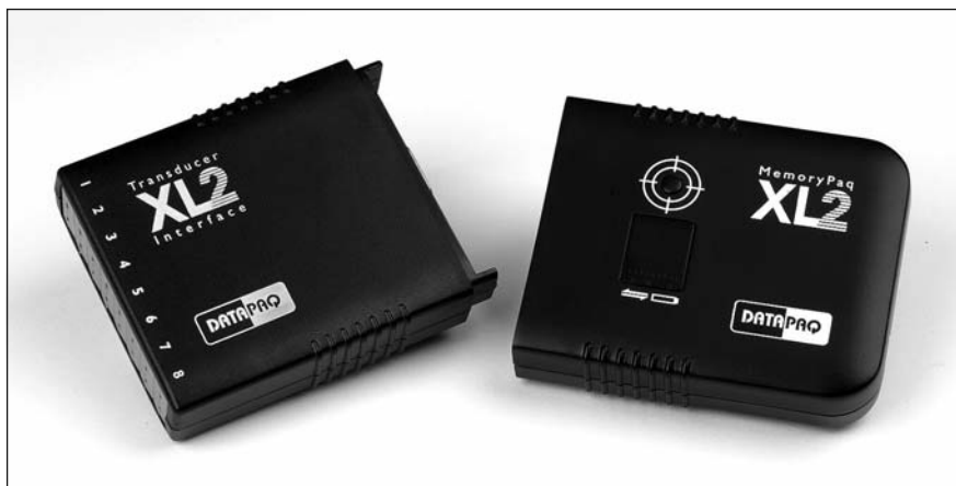
基本 XL2 ロガー：8 チャンネル変換器インタフェース（左、熱電対が表示されている）と MemoryPaq（右）
