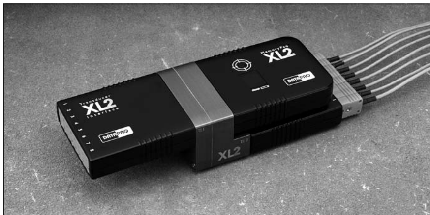
XL2 ロガー：MemoryPaq（右上）にデュアルインタフェースブロック（中）と二つの変換器インタフェース（左と右下）が装着されている。
