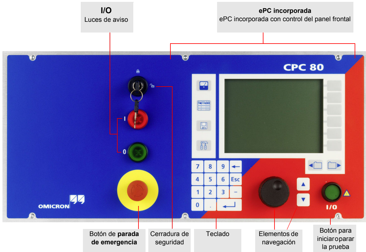
Figura 3-1: Panel frontal del CPC 80 con luces de seguridad, botón de parada de emergencia y ePC
