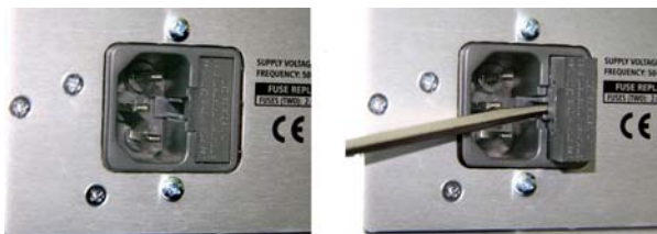
Module d'entrée d'alimentation Retrait du porte-fusibles
