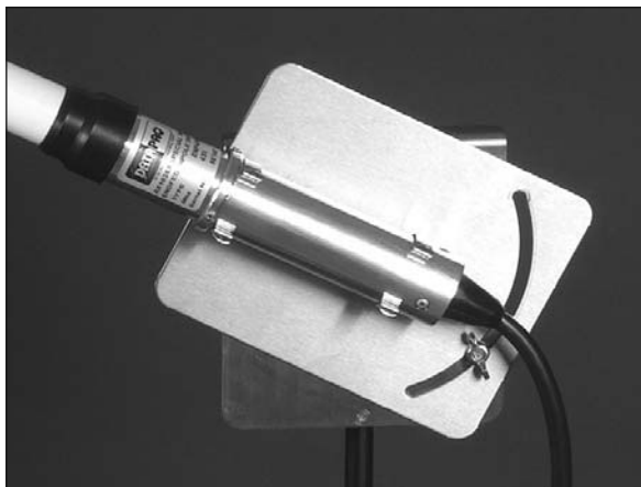
Korrekte Anbringung der Hochleistungsantenne an der rotierenden Klemm- vorrichtung des Stativs.
