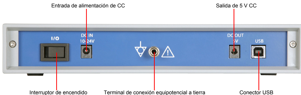
Figura 3-2: Vista posterior de DIRANA
