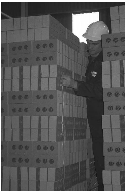
Sistema Kiln Tracker listo para monitorear ladrillos durante el horneado.
