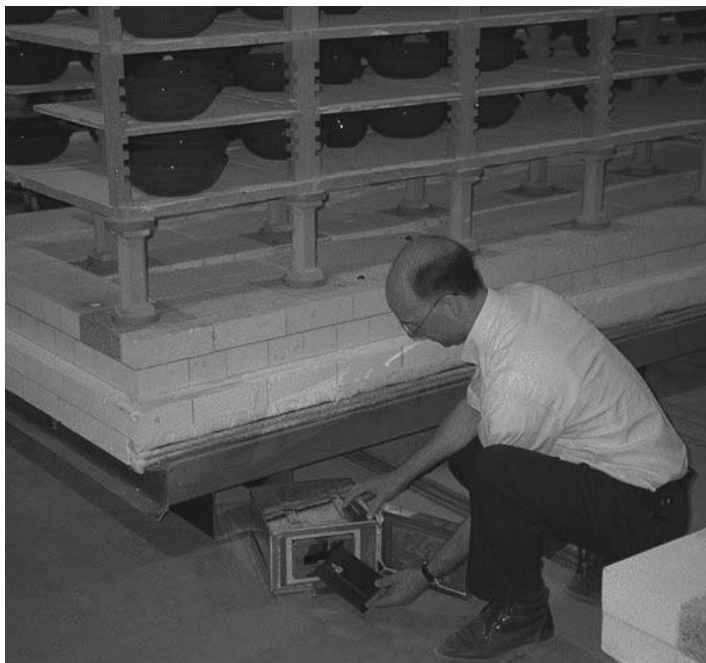
Registrador de datos siendo instalado en la barrera térmica.
