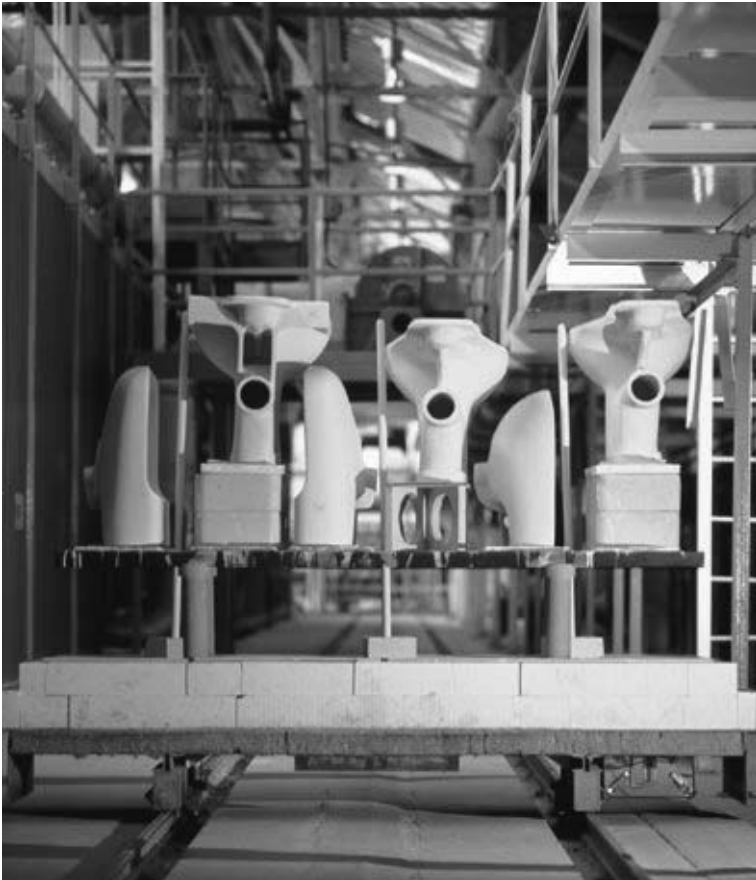
Un carro de horno cargado con equipos sanitarios listo para entrar al horno.
