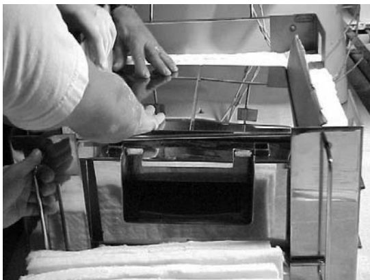
Colocación de la barrera térmica dentro de las capas de aislamiento.
