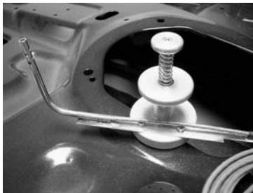
使用中のアルミニウム自動車プローブ – 表面プローブ (左) と空気プローブ (右)
