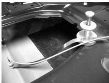
使用中のアルミニウム自動車プローブ – 表面プローブ (左) と空気プローブ (右)
