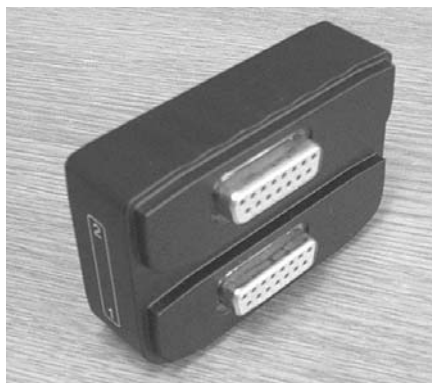
2つの変換器インタフェース用コネクタのあるデュアルインタフェースブロック
