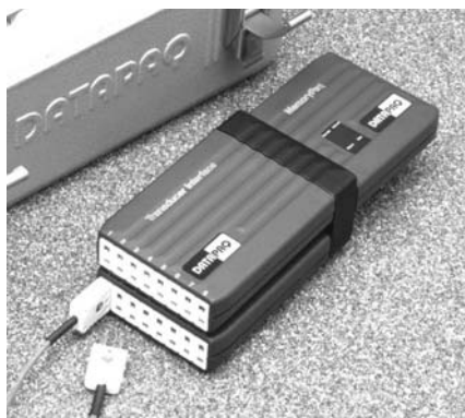
2つの変換器インタフェース及び MemoryPaq が接続されている使用中のデュアルインタフェースブロック
