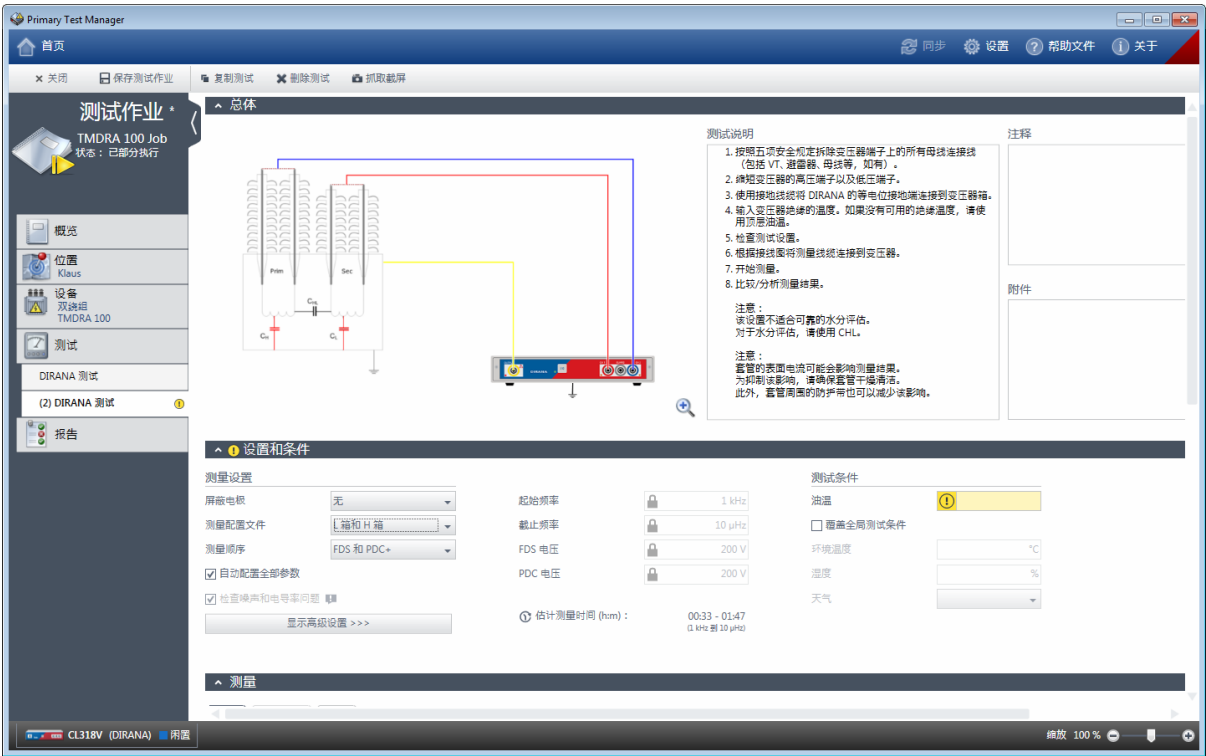
图 12-1：双绕组变压器的接线图示例
