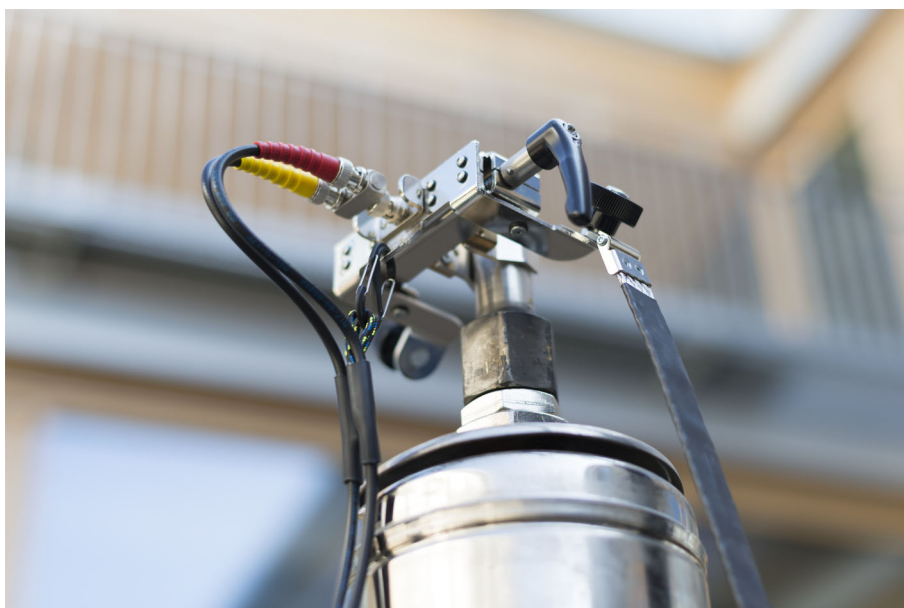
Rysunek 4-4: Podłączanie żółtego i czerwonego kabla koncentrycznego do cęgów przepustowych przy użyciu mechanizmu zwalniającego nacisku na osłonę BNC
