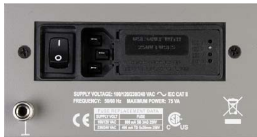
Figura 2. Detalle, módulo de entrada de energía en el panel posterior del instrumento APx. El interruptor de potencia está a la izquierda.
