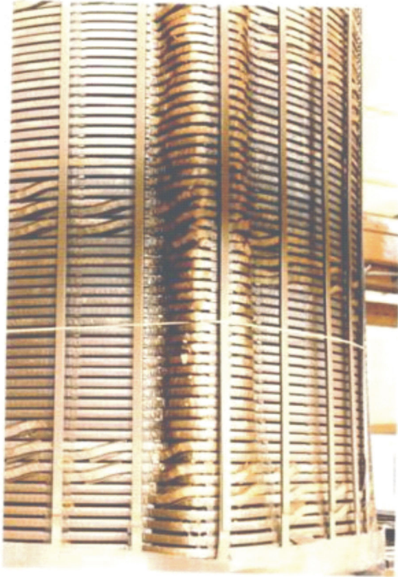
Εικόνα 3-3: Ακτινική παραμόρφωση πηνίου
