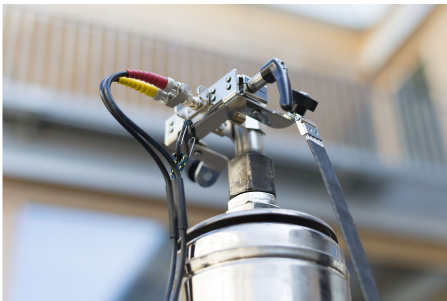
Εικόνα 4-4: Σύνδεση του κίτρινου και του κόκκινου ομοαξονικού καλωδίου στον σφιγκτήρα του μονωτήρα με χρήση του μηχανισμού εκτόνωσης της πίεσης στη θωράκιση BNC
