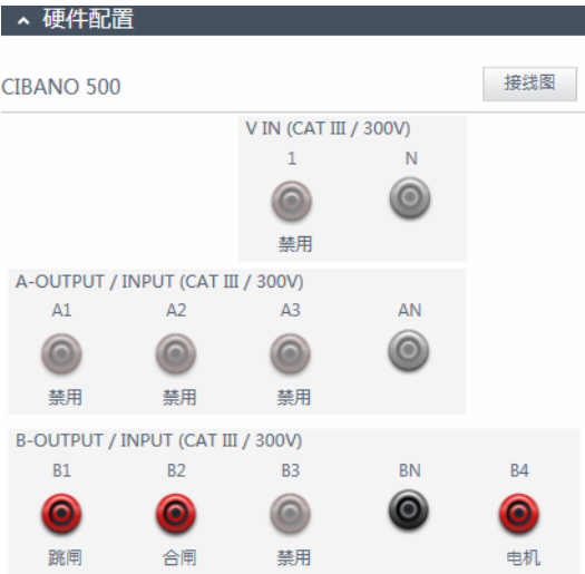
图 17-27：最低启动电压测试的硬件配置
