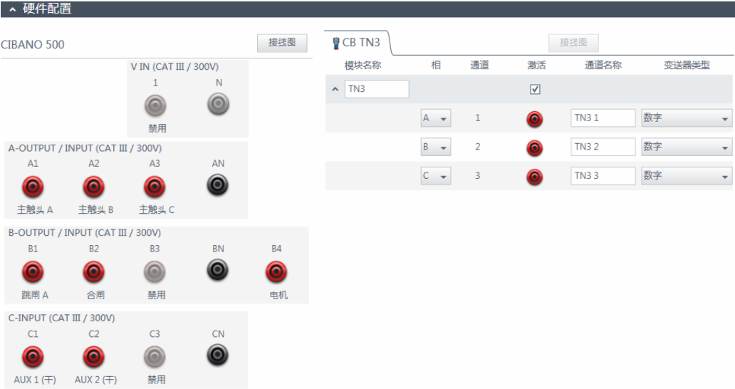
图 17-50: 时间测试的硬件配置示例，用于测量运行期间的主触头行程
