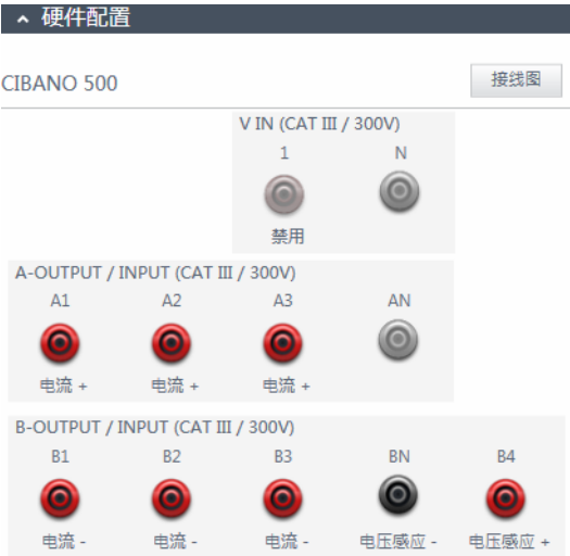
图 17-4：接触电阻测试的硬件配置
