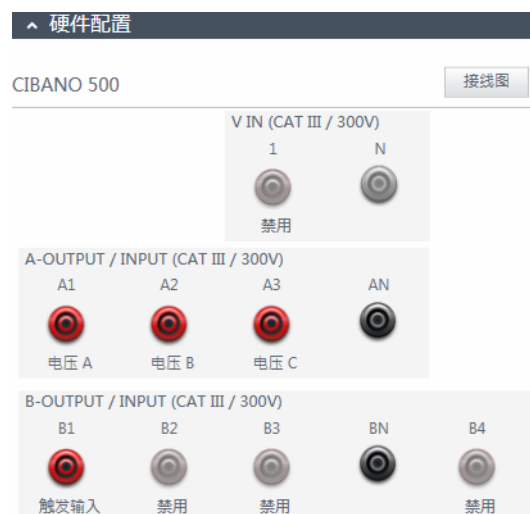
图 18-1：时间（使用中）测试的硬件配置
