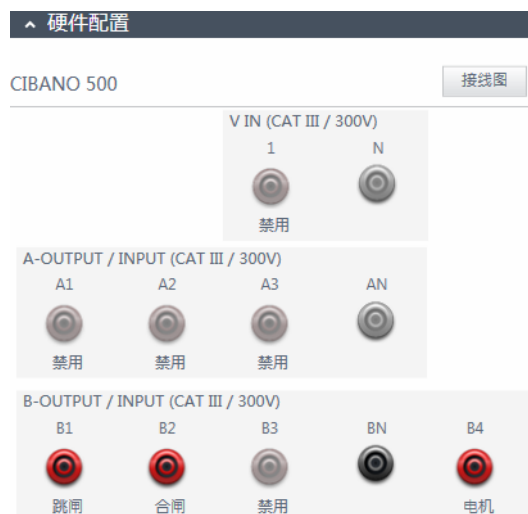
图 17-43：最低启动电压测试的硬件配置
