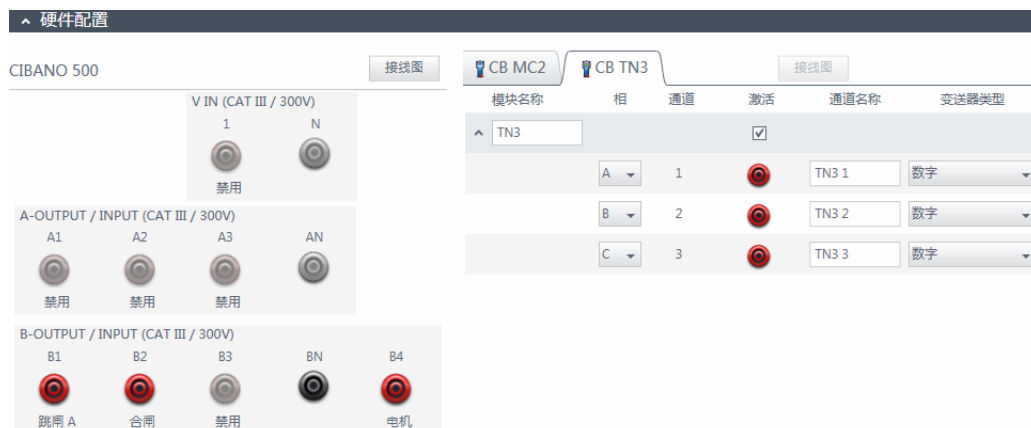
图 17-53: 动态接触电阻测试的硬件配置示例，用于测量运行期间的主触头行程
