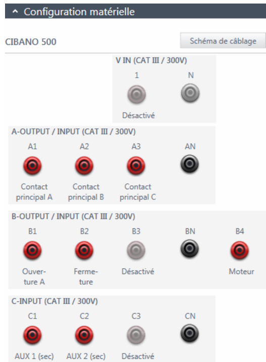
Figure 17-8: Configuration matérielle du test des temps
