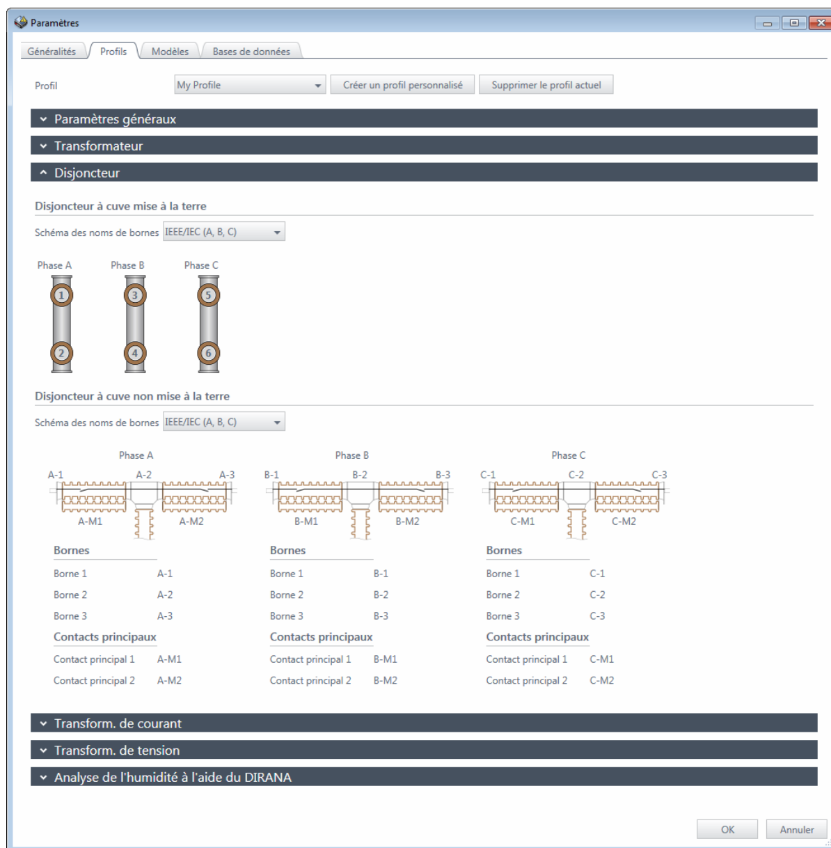
Figure 6-4: Onglet Profils : disjoncteur
