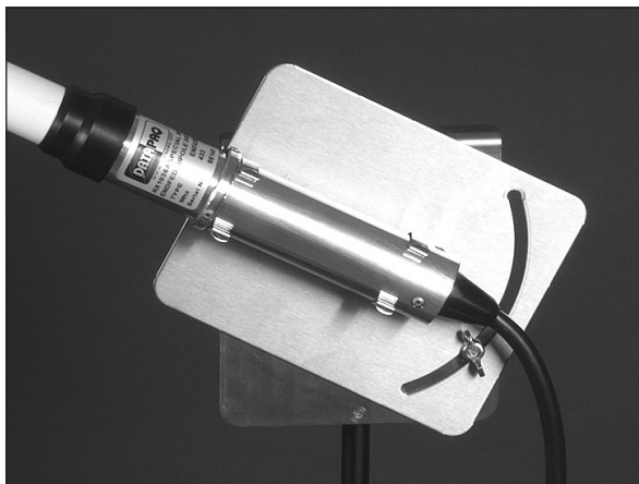
안테나 스탠드의 회전 클램프에 올바르게 장착된 단위 게인 엔드-피드 안테나.
