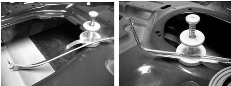
Sondes automobile en fonctionnement – sonde de surface (à gauche) et sonde d'air (à droite).
