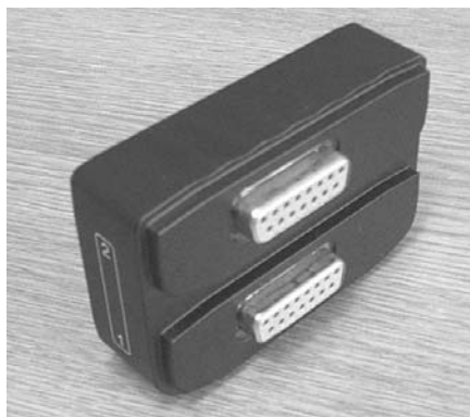
Bloc d'interface double, avec connecteurs pour deux interfaces de transducteur.
