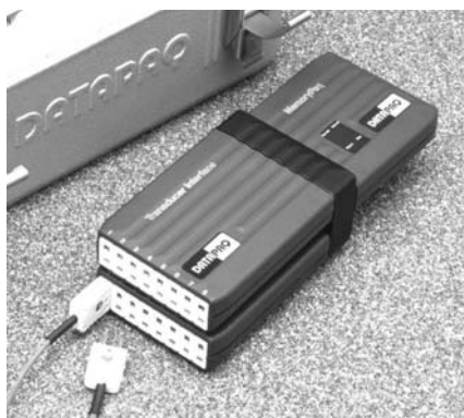
Bloc d'interface en cours d'utilisation, connecté à deux interfaces de transducteur et à un système MemoryPaq.
