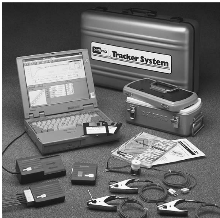
Composants du système Oven Tracker XL, avec ordinateur portable (le chargeur n'apparaît pas ici).
