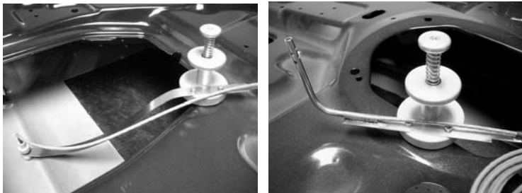
Messfühler für Aluminiumteile in der Automobilindustrie – Oberflächenfühler (links) und Luftfühler (recht).
