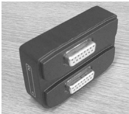
Doppelschnittstelle mit Anschlüssen für zwei Transducer-Schnittstellen.
