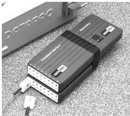
Doppelschnittstelle mit angeschlossenem MemoryPaq und zwei Transducer-Schnittstellen.
