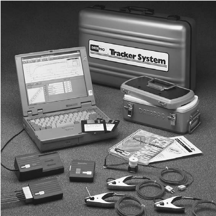
Bestandteile des Systems Oven Tracker XL mit einem tragbaren PC (Ladegerät ist nicht abgebildet).
