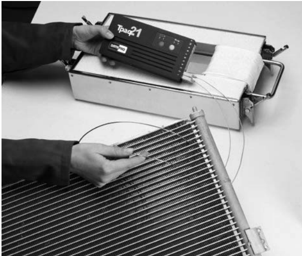
Sondas de termopar fijándose a una pieza de radiador de prueba.
