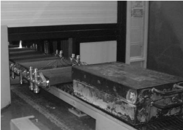
Barrera del horno con sondas conectadas a la pieza de prueba.
