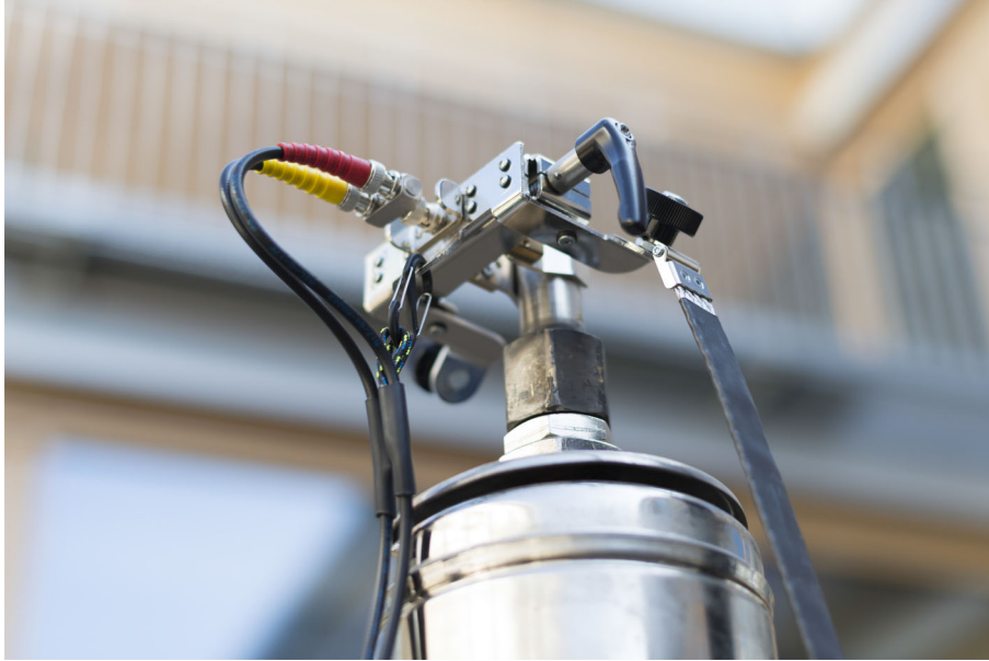
Şekil 4-4: BNC blendajındaki basıncı tahliye etmek için mekanizmayı kullanarak sarı ve kırmızı koaksiyel kabloları buşing klampına bağlama
