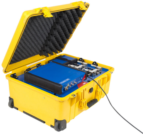
Şekil 4-2: FRANEO 800 'ü birlikte verilen USB 2.0 A/B kablosuyla bilgisayara bağlama
