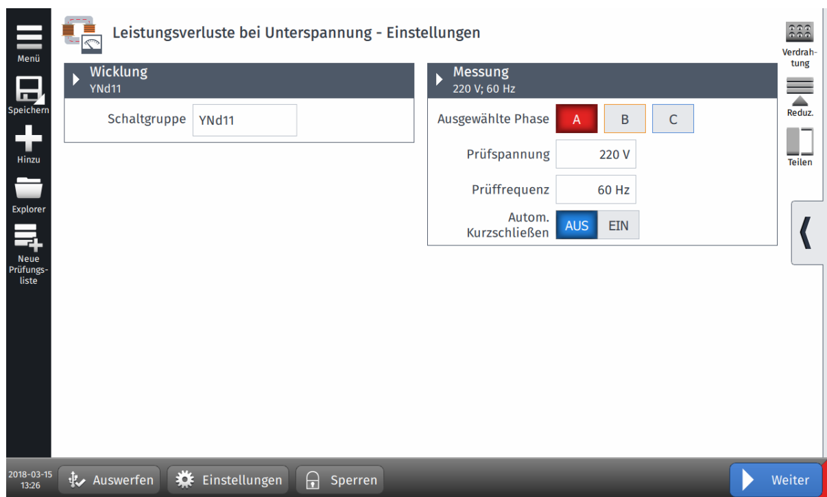
Abbildung 8-17: Einstellen-Ansicht für Leistungsverluste bei Unterspannung
