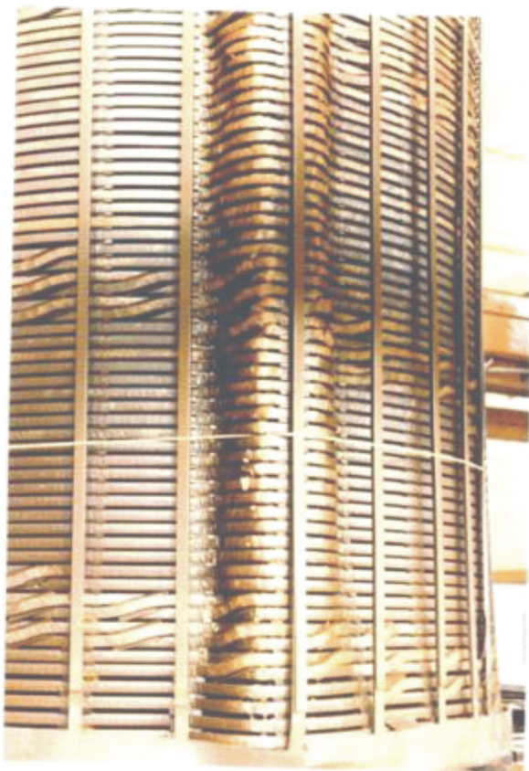
Figura 3-3: Deformação da bobina radial
