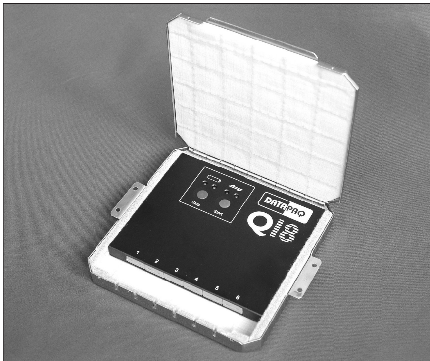
Registratore dati Q18 inserito nella barriera termica TB7400, per l'uso in processi di rivestimento antiriflettente.
