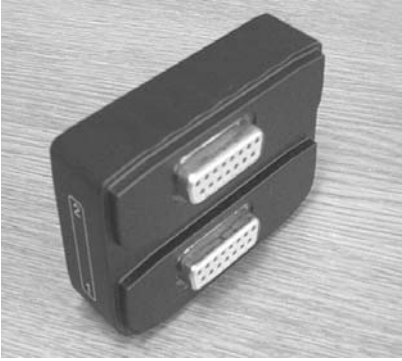
双接口块，带有两个变换器接口的接头。
