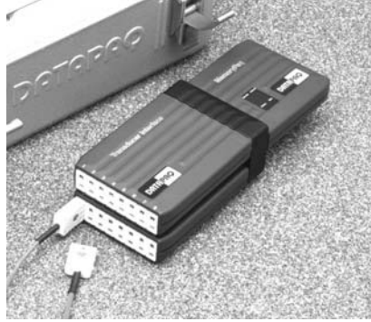
使用中的双接口块，接有两个变换器接口和一个MemoryPaq。
