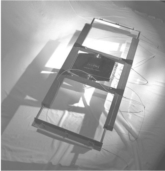
TB0031 型伸缩臂 StenterPaq 系统。扩展臂（上和下）可以调节以适应烘炉的具体情况。扩展臂上的弹簧可使6个热电偶探头与织物保持良好接触。位于中心的隔热箱内含并保护着记录器。
