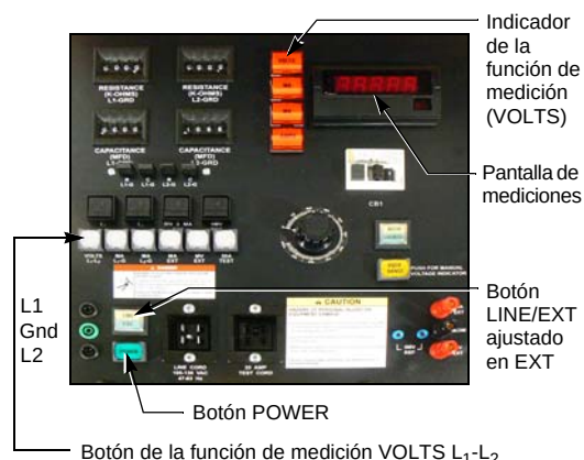
Figura 9: Ajuste de la tensión de línea a línea (externa)
