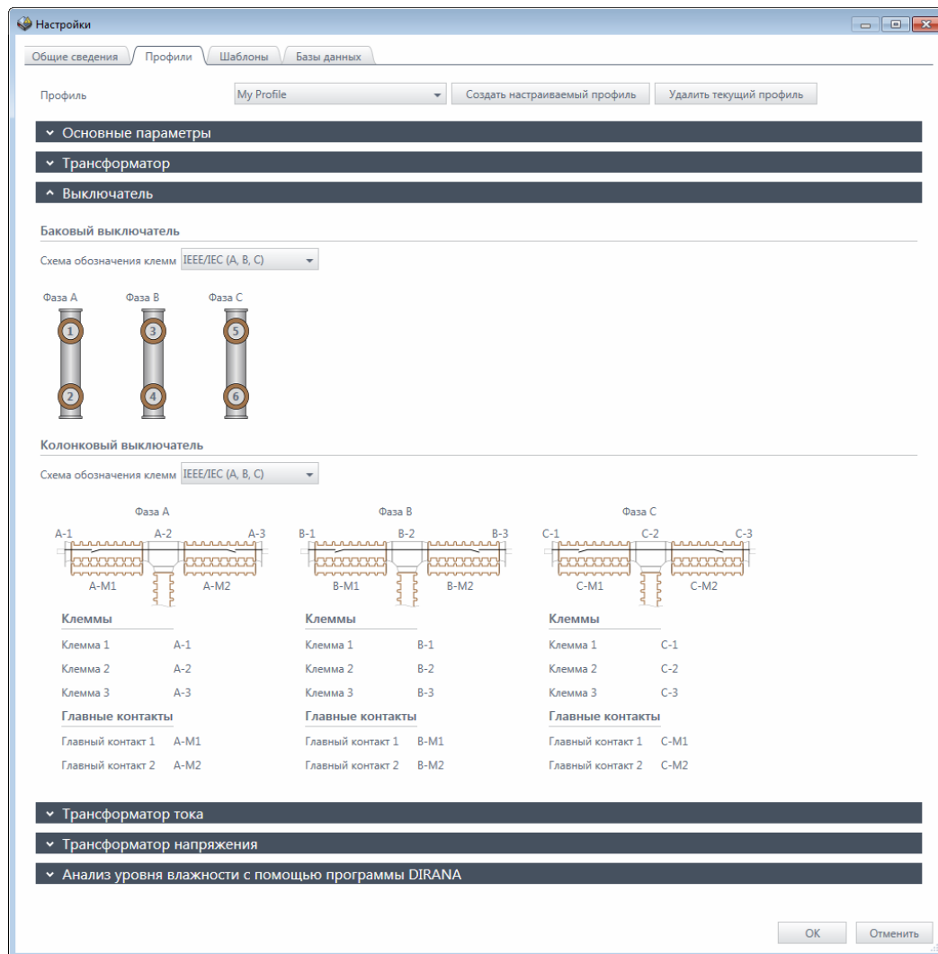
Рис. 4-5: Вкладка Профили Силовой выключатель
