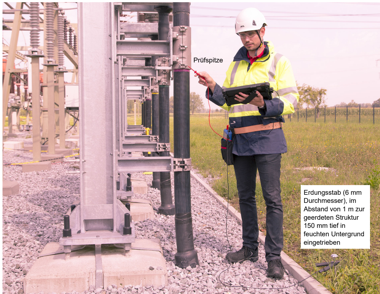
Abbildung 8-12: Berührungsspannungsmessung gemäß IEEE 81 mit PTM-Software auf Tablet
