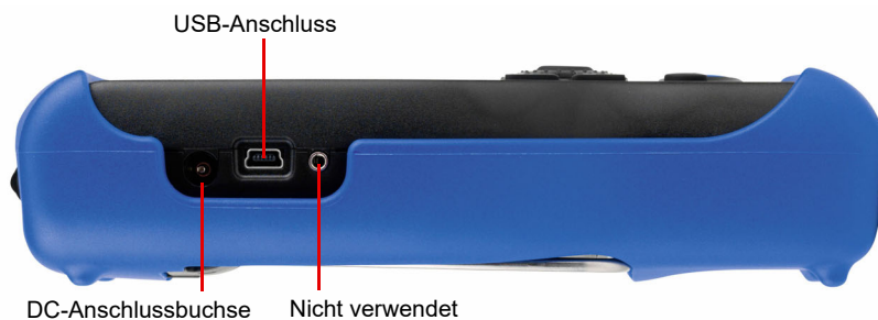
Abbildung 3-4: Anschlüsse auf der linken Seite des HGT1
