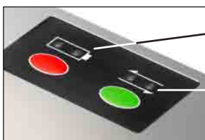
LEDs für Batteriestand Gelb und grün/rot LEDs für Loggerstatus Rot und grün
