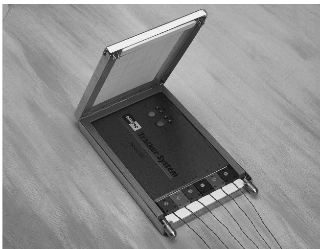
Registratore inserito nella barriera termica.
