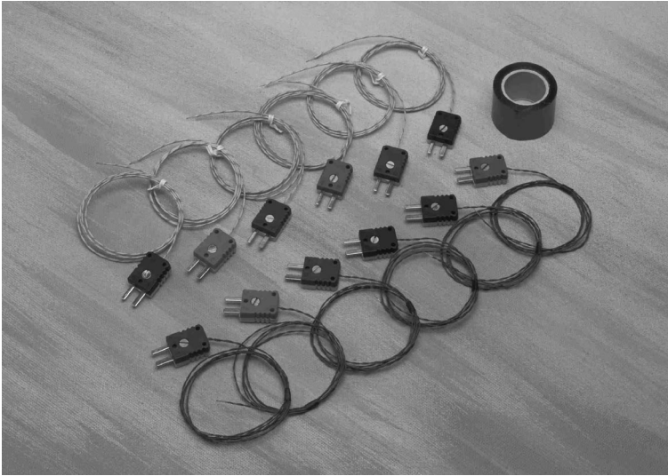
Tipico kit sonde per Reflow Tracker.
