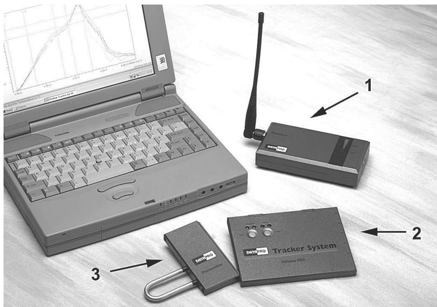
Moduli per radiotelemetria per Reflow Tracker. 1: Ricevitore 2: Registratore dati Datapaq 9000 3: Trasmettitore
