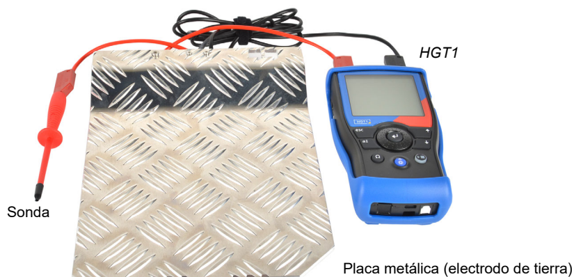
Figura 8-13: Configuración de hardware según el estándar EN 50522
