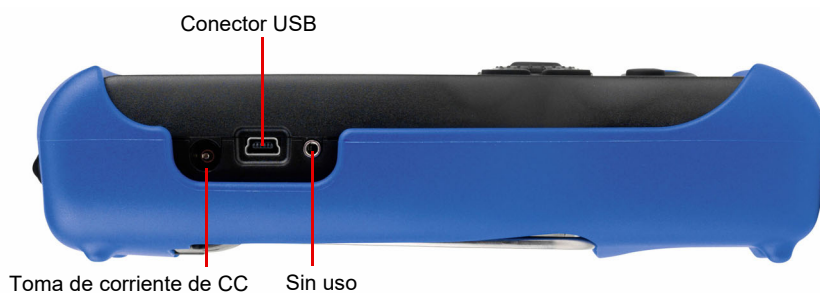
Figura 3-4: Conectores de la unidad HGT1 , lado izquierdo
