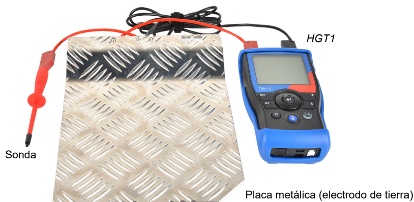
Figura 8-7: Configuración de hardware según el estándar EN 50522
