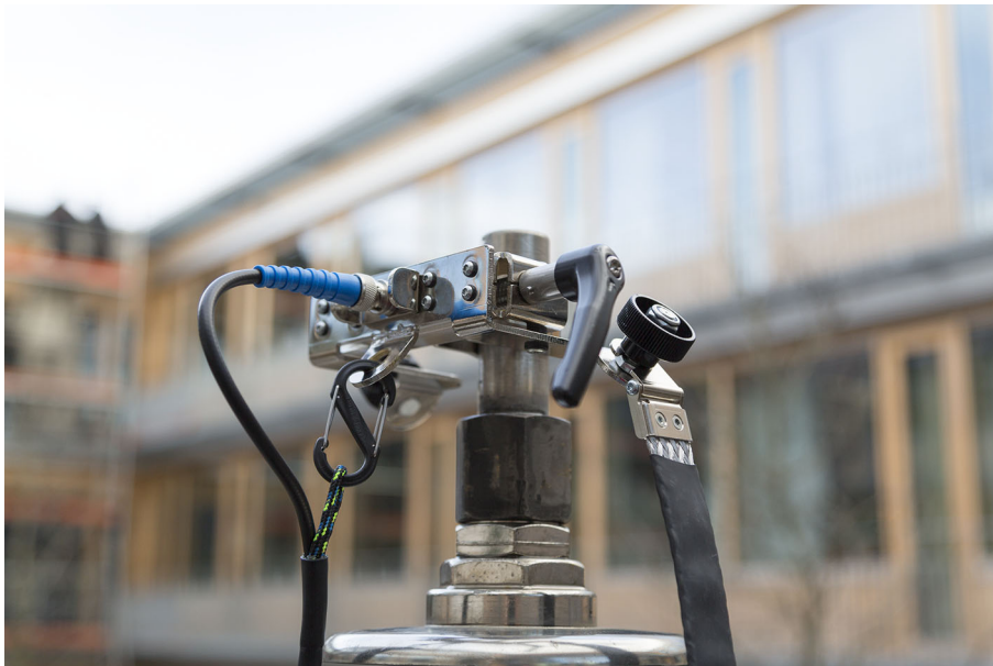
Figure 4-7: Connexion du câble coaxial bleu à la pince pour traversée à l'aide du mécanisme de détente au niveau du blindage BNC
