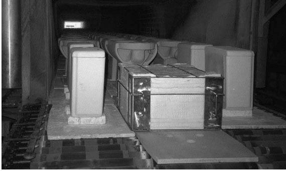
温度跟踪仪系统正在进入窑炉
