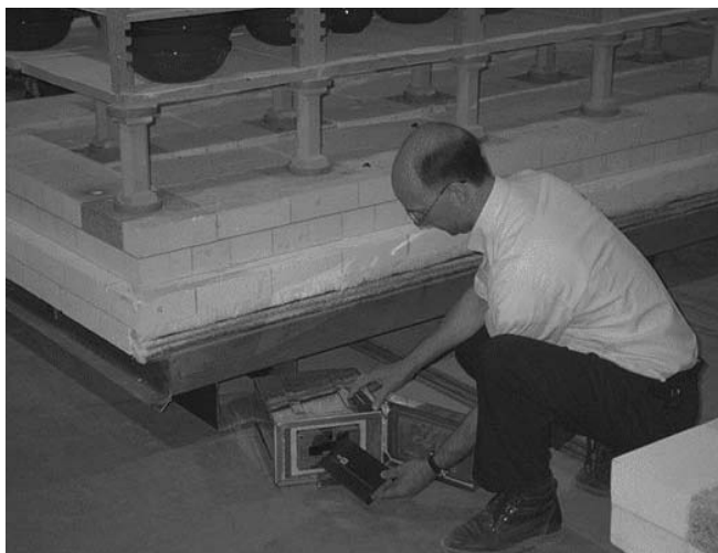
正在装入隔热箱的数据记录器
