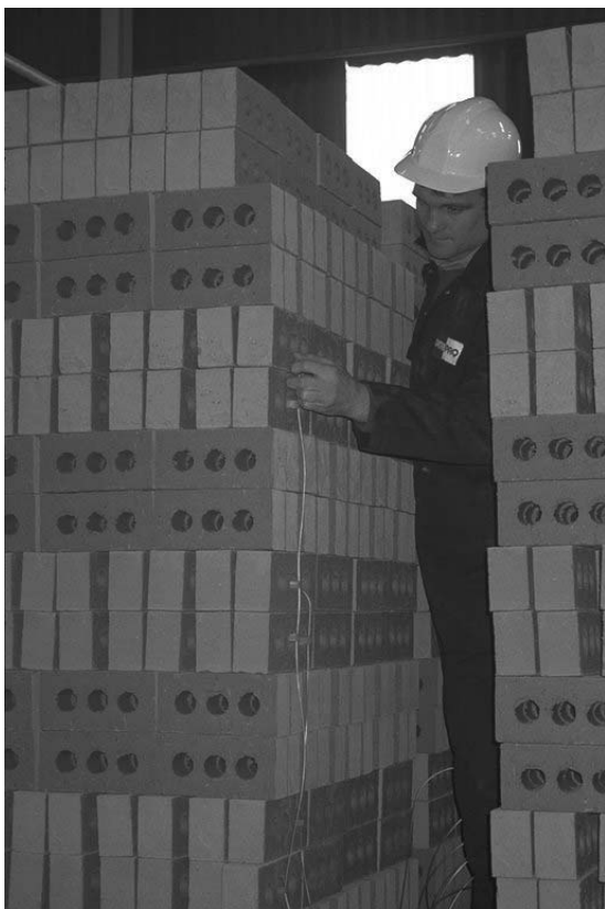
窑炉温度跟踪仪系统已准备好在烧制期间对砖进行监控
