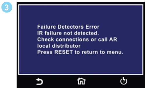
IR Fail Detectors ERROR screen.
