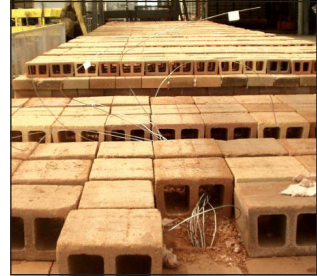
Termocoppie che dai mattoni refrattari passano attraverso la base del carrello del forno.
