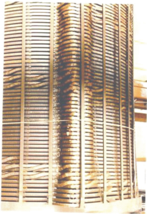
Figura 3-3: Deformare radială a unei bobine
