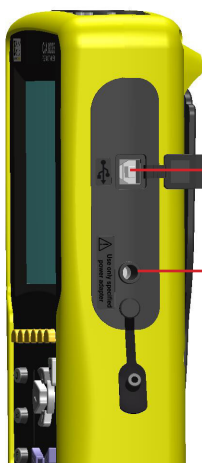
Figura 4: los conectores en el lateral derecho
