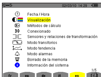
Figura 6: la pantalla de visualización de los submenús
